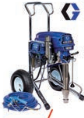
GRACO MARK VII HD STANDARD PULVÉRISATEUR ÉLECTRIQUE AIRLESS Débit maxi : 6 l/mn Pression 227 bars - 1900W Hauteur 75 cm roues semi-pneumatiques Hi-Boy réf. 17E665
